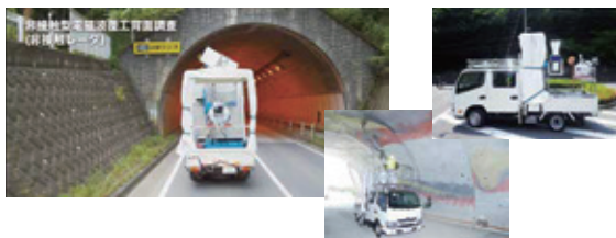
多機能防災車による道路トンネルパトロール 「トンネルマスター」
